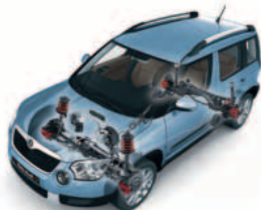
Die elektronisch gesteuerte Haldex-Kupplung des Allradantriebs verteilt die Antriebskräfte variabel auf beide Achsen. So reagiert der Yeti blitzschnell auf wechselnde Fahrbahnzustände.
