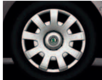
Stahlfelgen und Radzierblenden Tempel 7,0J x 16" mit 205/55-R16-Bereifung, Serie bei Active.
