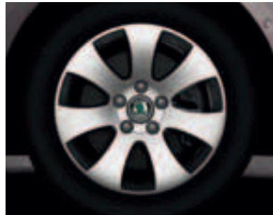
Leichtmetallfelgen Spectrum 7,0J x 16" mit 205/55-R16-Bereifung, optional für Active (außer 2,0 l TSI/147 kW), Serie bei GreenLine.
