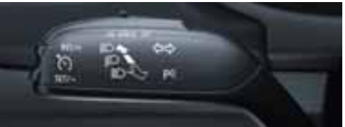
Geschwindigkeitsregelanlage für alle Motorisierungen: für Fahrzeuge ohne Bordcomputer (5J1 035 623)*, für Fahrzeuge mit Bordcomputer (5J1 035 623A)*
