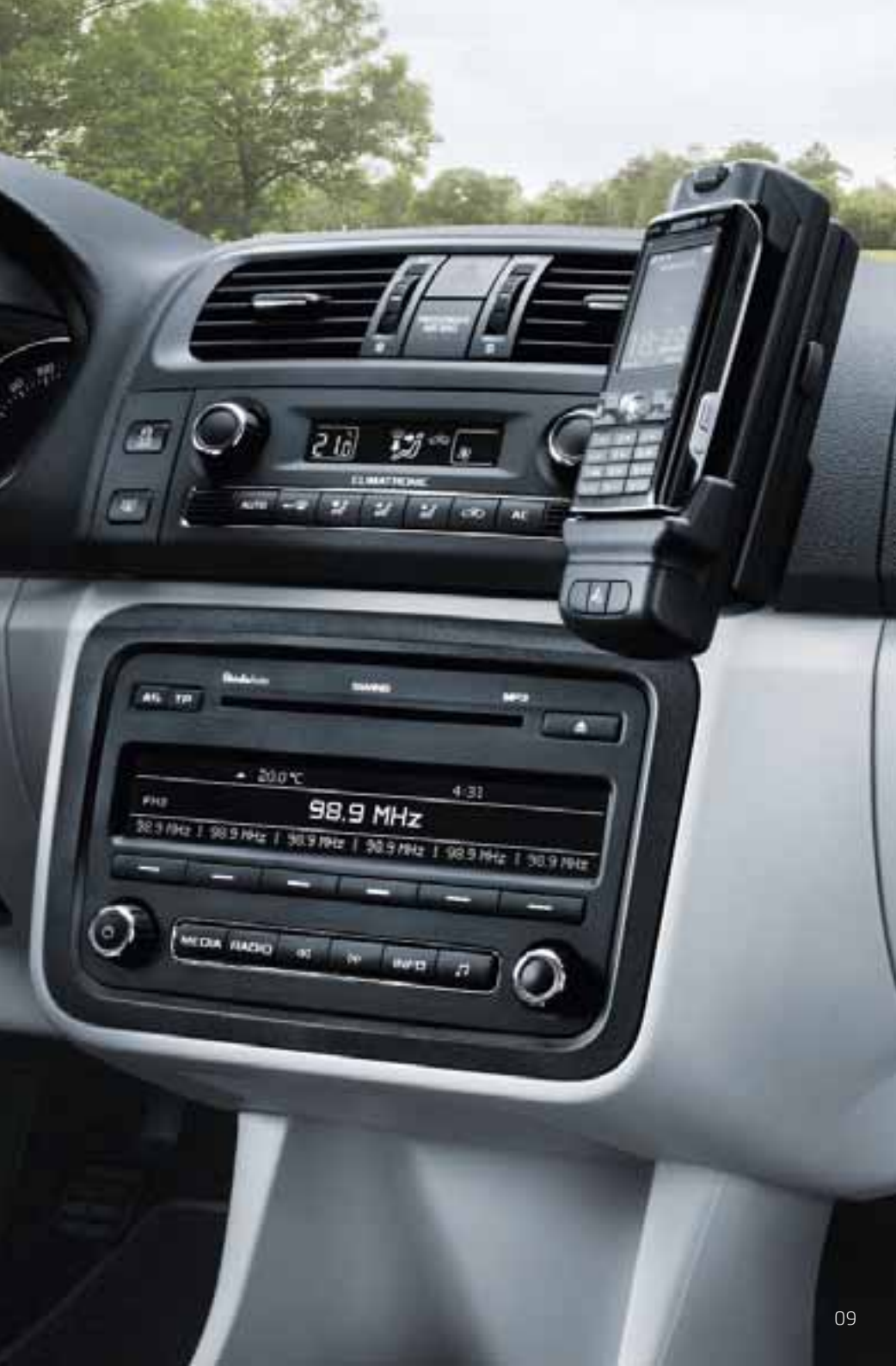
Das Musiksystem Swing ist mit einem AM/FM-Radio mit RDS- und TP-Systemen, einer Dualantenne für hervorragenden Empfang, einem CD-Player, auch für MP3- und WMA-Dateien, einem Verstärker (4x 20 W) und einem digitalen Signalprozes- sor mit Equalizer ausgestattet. Zusätzlich zu dem akustischen Signal der Park- sensoren wird auf dem Display die Entfernung zu einem Hindernis aufgezeigt (5J0 035 161C).
