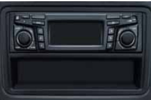
Einbausatz für Autoradios anderer Hersteller (AZO 700 001), bei Fahrzeugen mit Werksvorrüstung für ein ŠKODA-Radio ist der zusätzliche Einbau des Adapters (AZA 700 001A) erforderlich.
