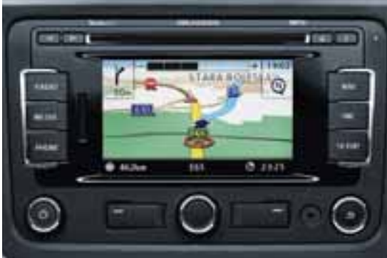
Das dynamische Radio-Navigationssystem Amundsen lässt sich über ein 5"-Touchscreen-Display (TFT) bedienen. Das System ist CD-gesteuert. Neben einem Line-in-Audio- anschluss direkt am Gerät und einer Abspielfunktion für MP3-Musikdateien verfügt es über einen zusätzlichen Kartenleser für SD-Karten zum Abspielen von MP3- und WMA-Dateien (AAN 800 002).
