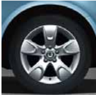
Leichtmetallfelge Avior* 6,0J x 15" für Reifengröße 195/55 R15 (CCH 700 005)
