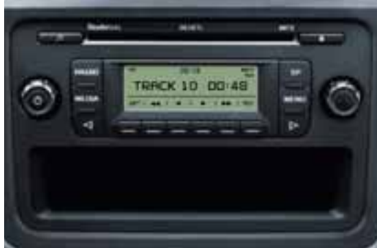
Das Musiksystem Blues verfügt über ein AM/FM-Radio mit RDS-System, einen 1-DIN-CD-Spieler mit Abspielfunktion für MP3-Musikdateien auf CD und einen Verstärker mit 4x 20 W. Dank einer elektronischen Diebstahlschutzkodierung funk- tioniert es nur in Ihrem Fahrzeug (5J0 035 152A).
