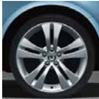
Leichtmetallfelge Trinity* 7,0J x 17" für Reifengröße 205/40 R17 (5J0 071 496A)
