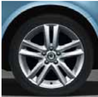
Leichtmetallfelge Elba* 6,5J x 16" für Reifengröße 205/45 R16 (5J0 071 494A)
