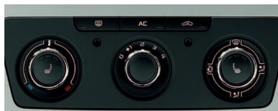
Mit der **Klimaanlage** lassen sich der Temperaturbereich, die Intensität und Richtung der Luftströmung manuell einstellen.
