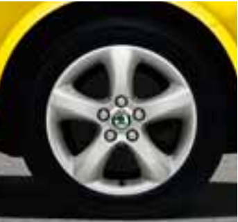
Leichtmetallfelge Antares 6,0J x 15" für Reifengröße 195/55 R15 (CCH 700 004)
