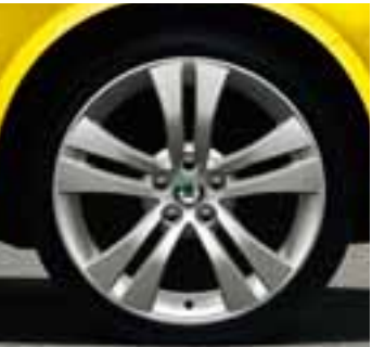
Leichtmetallfelge Trinity 7,0J x 17" für Reifengröße 205/40 R17 (5J0 071 496A)*
