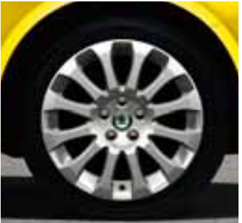
Leichtmetallfelge Comet 6,5J x 16" für Reifengröße 205/45 R16 (5J0 071 494)
